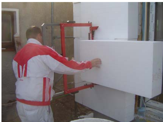
Heißdraht-Styropor-Schneidemaschine für Wärmedämmverbundsystem
