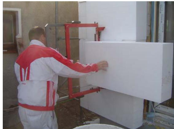
Heißdraht-Styropor-Schneidemaschine für Wärmedämmverbundsystem
